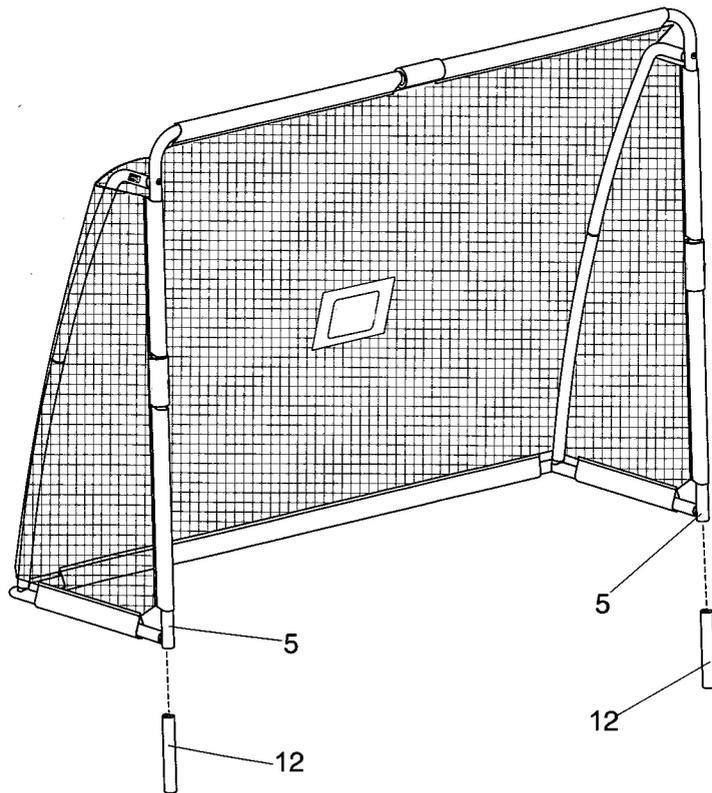
Wählen Sie zunächst einen ebenen Boden oder eine ebene Grasfläche, vergewissern Sie sich, dass Ihre Montageeinheit mindestens 3 Meter Abstand von anderen Bauwerken oder Hindernissen hat. Dann schlagen Sie die zwei Bodenspikes (13) mit den dazugehörigen Ankerrohren (12) mit einem Stahl- oder Gummihammer in den Boden. Dann führen Sie das Ankerrohr (12) in die Bodenspikes (13) wie abgebildet.
